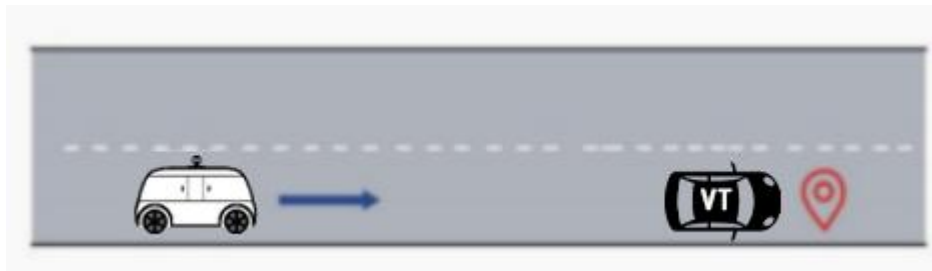
图 22 静止车辆占用停车点场景示意图
