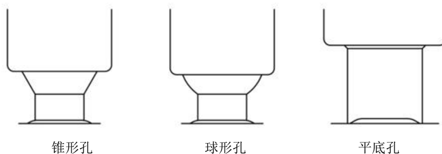
图3 常见车轮螺栓孔的形式
