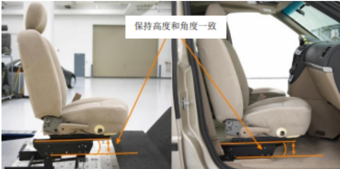
图1 座椅在车辆和台车上的安装
