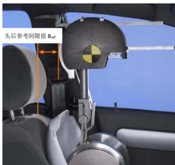
图 5 测量假人定位用的头后间隙参考值
