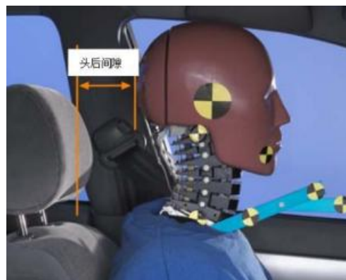
图 7 测量假人的头后间隙
