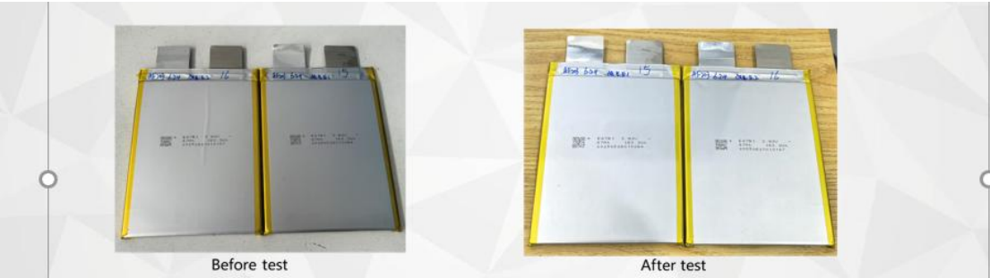
图 5 低气压试验前后对比
