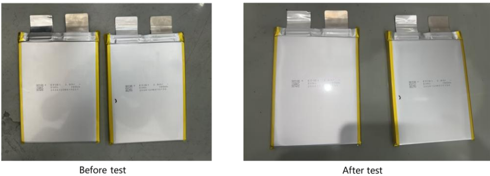
图 7 热滥用情况下电池形貌
