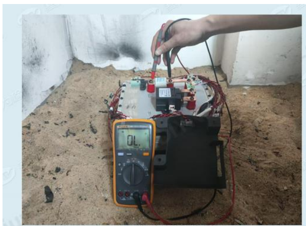
图 2 外部短路测试
