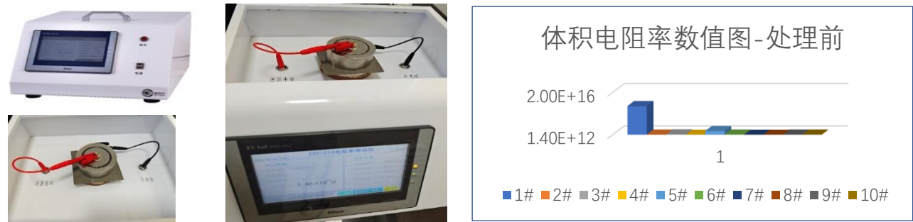
图 4 体积电阻率测试过程和测试数据
