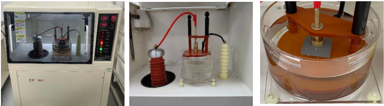
图 3 击穿电压测试过程
