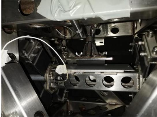
**实验过程：**把裁剪好的长度为 100mm 的不同断面的密封条安装在上部支架上（采用 3M 胶带或胶水粘贴），其次，把摩擦匹配材料装夹在水平安装支架上，水平安装的样品为平整样品，采用胶带或螺栓固定的方式固定。依次按照 10N、20N、30N、40N（或设计要求的密封条反力）作为试验中的正压力，1mm/s 和 4mm/s 的速度（或有特殊要求的速度）分别对材料进行相对运动下噪声水平的测试。
