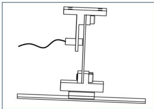
依次按照 10N、20N、30N、40N 的正压力，1mm/s 和 4mm/s 的速度分别对材料进行黏滑运动的测试。
