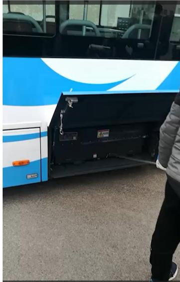
图 2 远距离应急解脱功能测试
