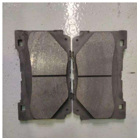
图 9 不均匀磨损后摩擦片 1
