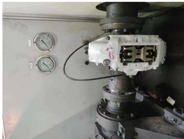
图 7 卡钳扭转疲劳强度测试 3
