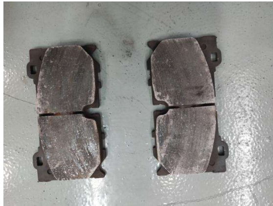
图 13 不均匀磨损后摩擦片 3
