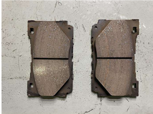
图 11 不均匀磨损后摩擦片 2
