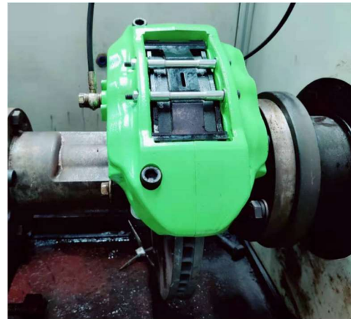
图 6 卡钳扭转疲劳强度测试 2
